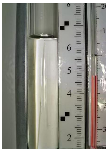
Рис. 3. Типовое изображение с камеры датчика-гидронивелира
