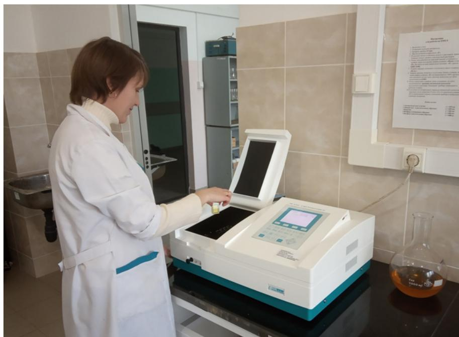
*Рис. 5. Определение фосфора на спектрофотометре УФ-6100*
