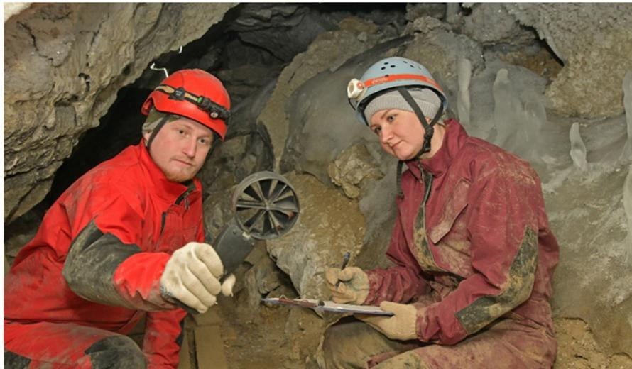
Рис. 6. Измерение скорости воздушного потока в проходе Горе Толстякам и Высоким
