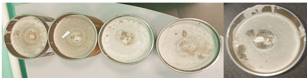
Рис. 2. Вид сверху «Сборки» с песчаником после испытаний – низкоскоростного индентирования [25]
