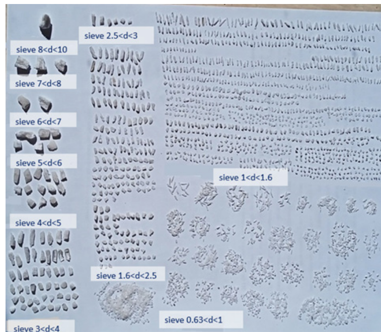
Рис. 16. Вид фрагментов, полученных в результате QSL кварцита (№2)
