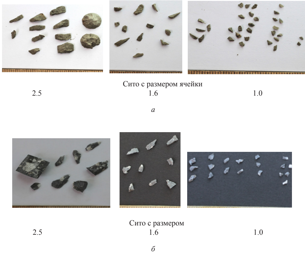
Рис. 9. Фотографии крупных (на верхних ситах) фрагментов образца песчаника №San6 (а) и андезита №Mou1 (б) после квазистатического нагружения
