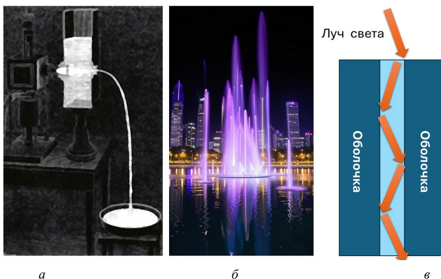
Рис. 1. (а) – опыт Тиндаля (1870 г.); полное внутреннее отражение в воде (б) и оптическом волокне (в)
