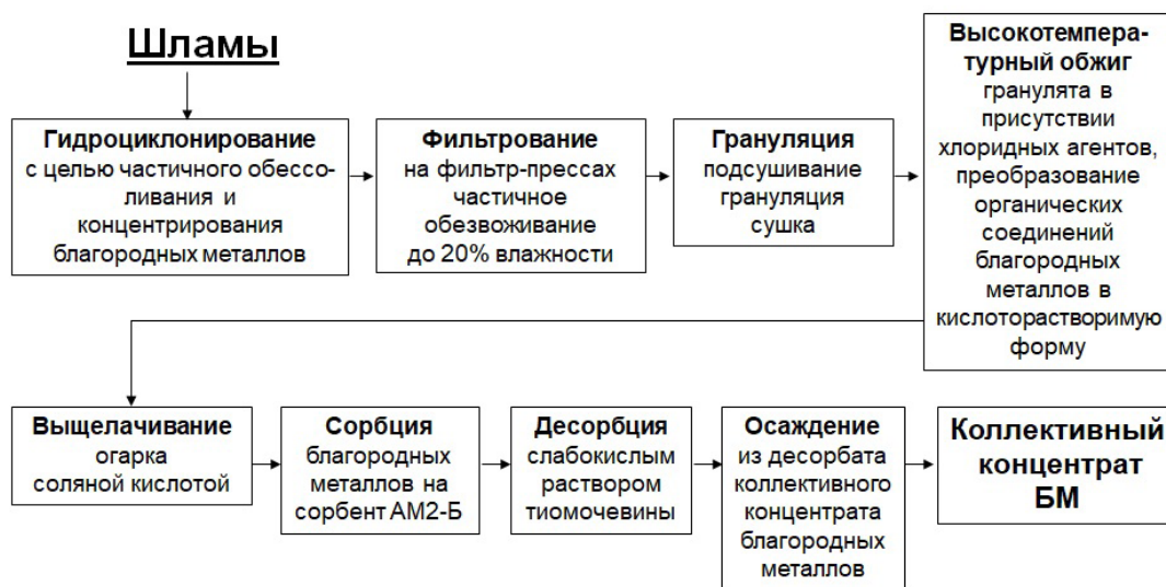
Рис. 3. Схема переработки галургических шламов
