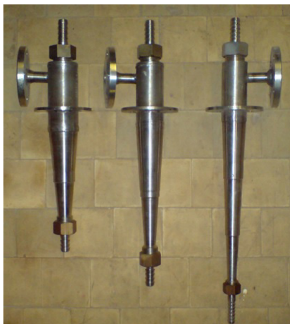
Рис. 4. 10-и, 7-и и 5-и градусный циклоны
