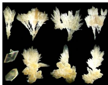
Рис. 10. Морфология кристаллов гипса с несколькими генерациями, образованных при медленном замерзании растворов: слева – общий вид кристаллов, справа – внутреннее каркасное строение кристаллов
