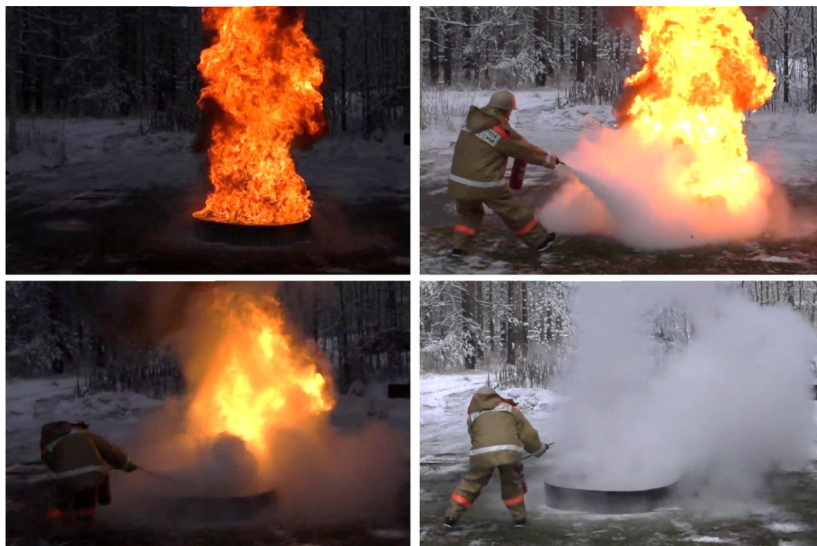
Рис. 9. Тест эффективности тушения модельного очага класса В (бензин, площадь 1,75 м 2 ) с огнетушителем (объем 2,5 л), заполненным разработанным ОПС
