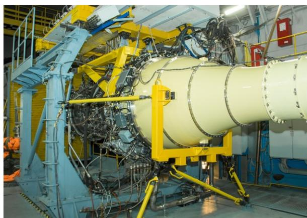
*Газогенератор новейшего двигателя большой тяги ПД-35 на испытательном стенде АО «ОДК-Авиадвигатель»*
