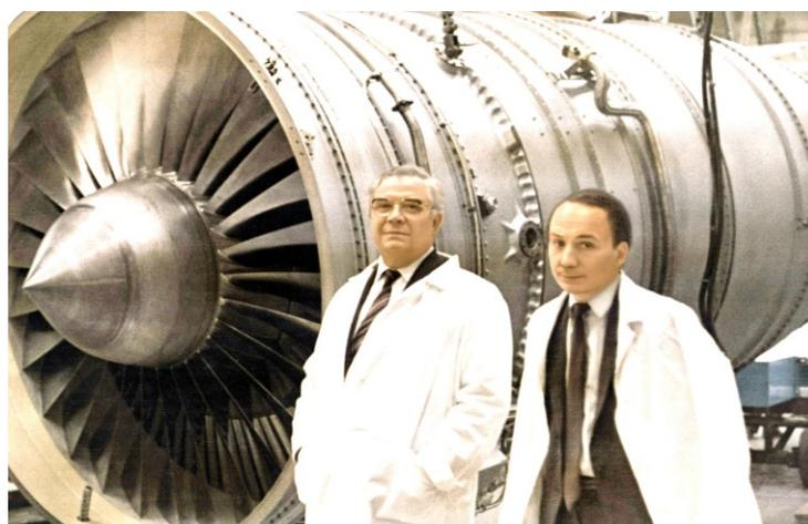
*Генеральный конструктор П.А. Соловьёв и главный конструктор А.А. Иноземцев у первого серийного двухконтурного газотурбинного двигателя ПС-90А*
