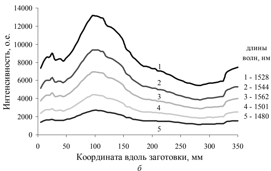
Рис. 5. Распределение интенсивности вдоль заготовки на разных длинах волн спектра люминесценции: а – соответствует заготовке, полученной методом пропитки, б – соответствует заготовке, полученной методом MCVD
