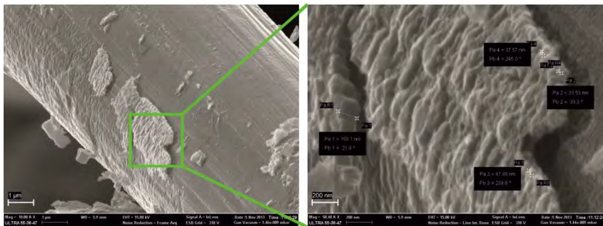
Рис. 2. СЭМ-изображения боковой поверхности углеродного волокна с карбидным слоем
