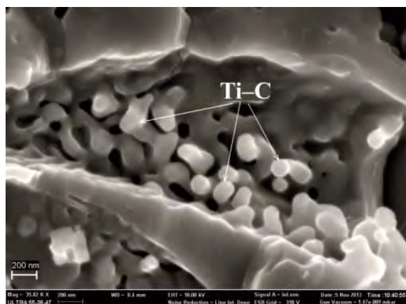
Рис. 3. Карбид титана в промежуточной зоне «титан – углеродный материал»
