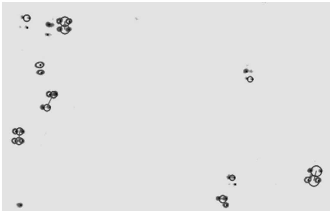
Рис. 17. Пример использования процедуры валидации по смещению парных бликов. Показано наложение результатов обработки двух последовательных изображений. Линиями показано смещение капель
