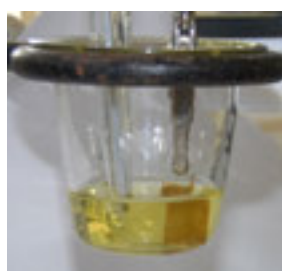
Электрод ИТО с полимером в окисленном состоянии
