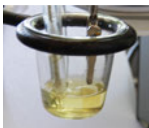
Электрод ИТО с сопряженным полимером в восстановленном состоянии
