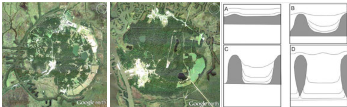
Рис. 1. Соляные диапиры в Луизиане (Avery Island, Weeks Island) и последовательность (A–D) формирования соляного купола по Бартону (1933)
