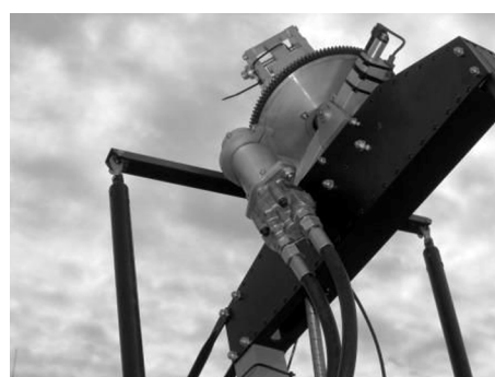
Рис. 3. Система гидравлической предварительной раскрутки
