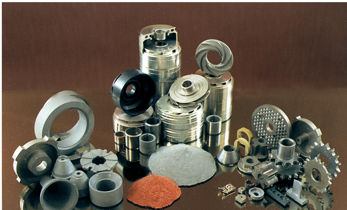
Рис. 2. Детали, полученные методом порошковой металлургии
