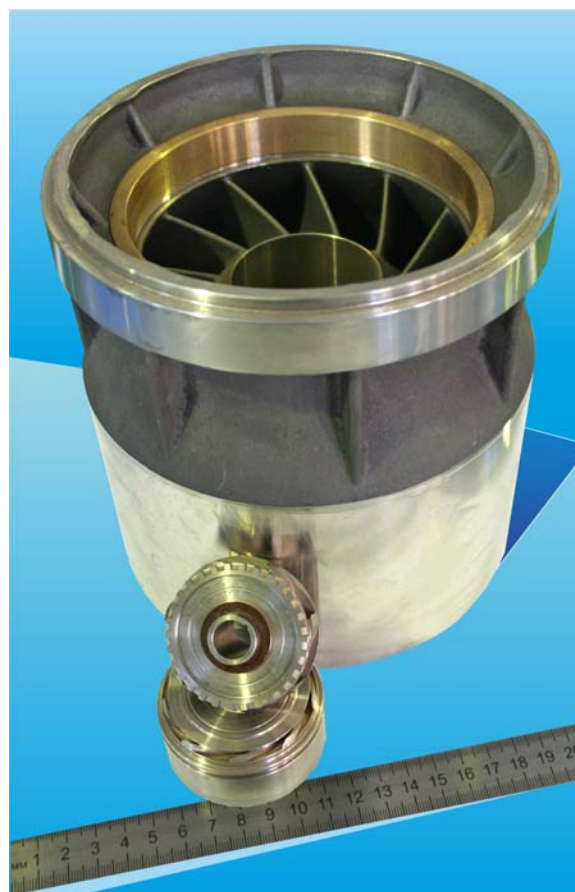
Рис. 9. Сравнительные размеры ступеней насосов
