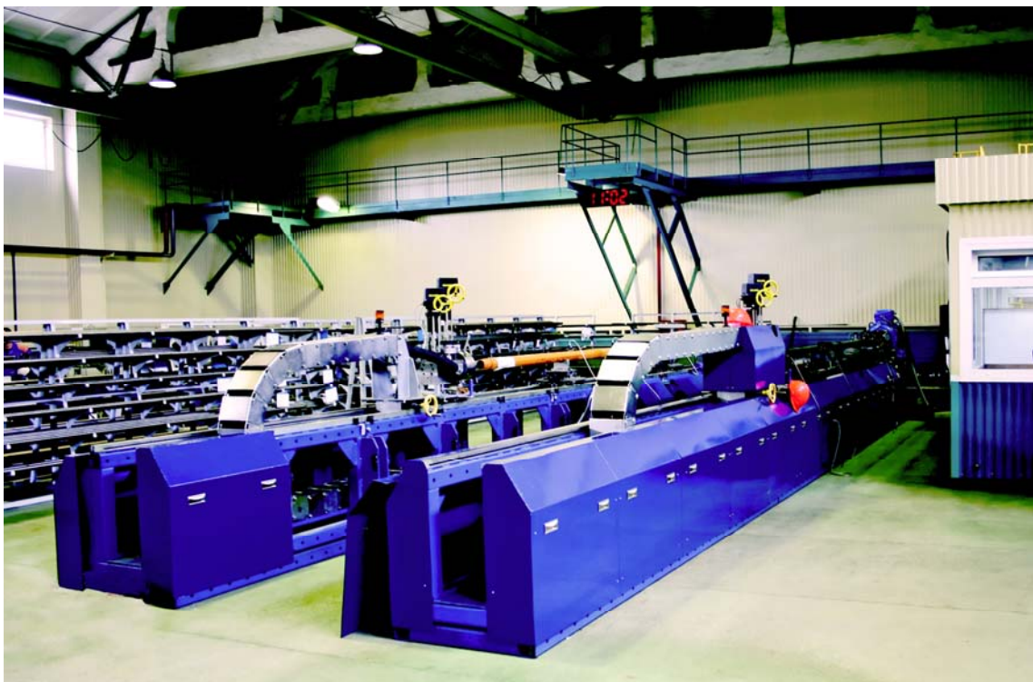
Рис. 6. Стенд для проведения прямо-сдаточных испытаний насосов
