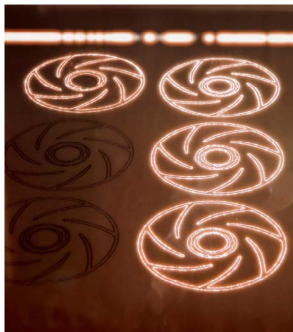
Рис. 8. Работа установки лазерного прототипирования
