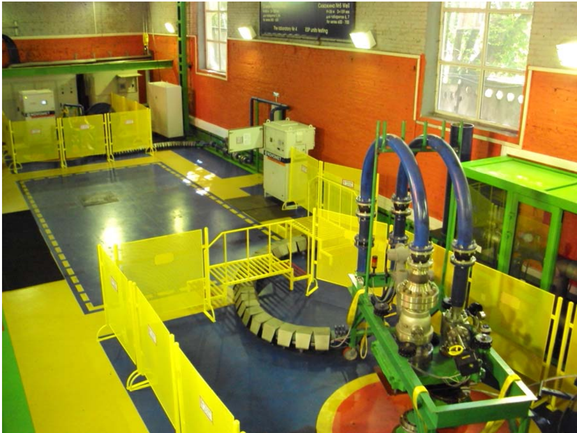
Рис. 5. Стенд-скважина для испытаний погружного оборудования
