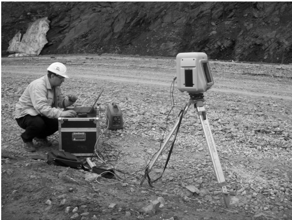
Трехмерное сканирование борта карьера Олимпиадинского ГОКа с использованием лазерного сканера (пос. Северо-Енисейский)
