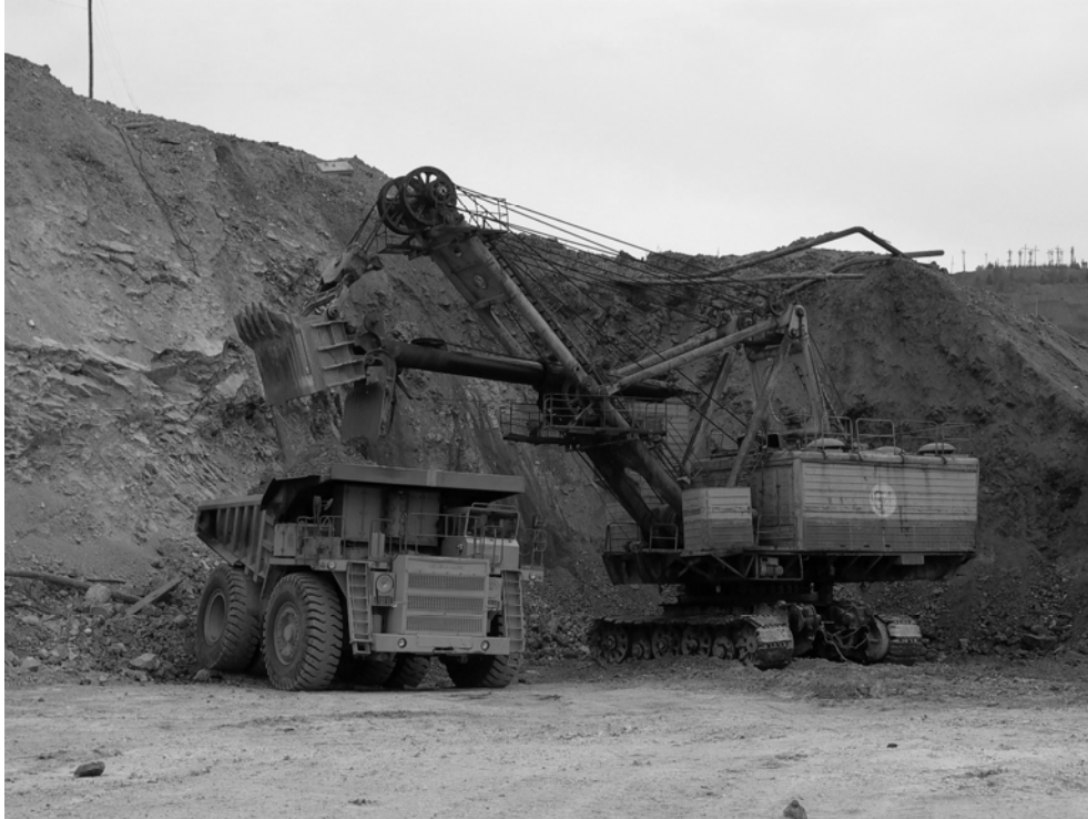
Погрузка горной массы на карьере Коршуновского гока (Восточная Сибирь)
