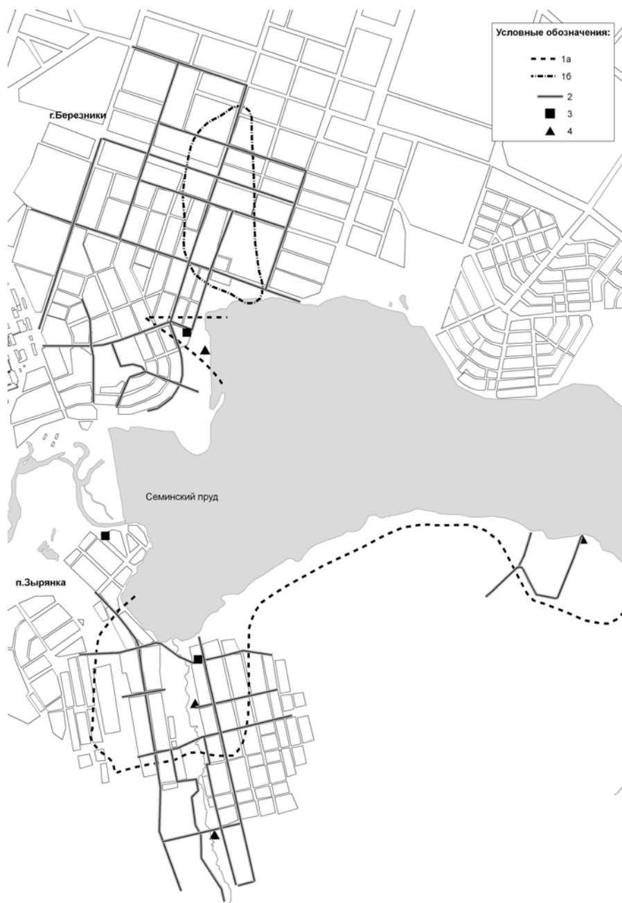
Рис. 4. Схема газогеохимического мониторинга за газовоздушными скоплениями в горных выработках: 1 – предполагаемые контуры газовых шапок в продуктивных пластах В (1а) и Кр II (1б); 2 – профили газогеохимического опробования; 3 – станции автоматизированного газогеохимического мониторинга; 4 – наблюдательные скважины
