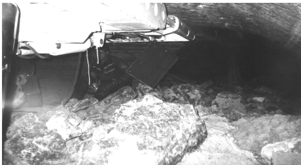
Рис. 7. Внезапный выброс соли и газа из почвы за крепью сопряжения в лаве № 50 рудника 1 РУ (вид призабойного пространства)
