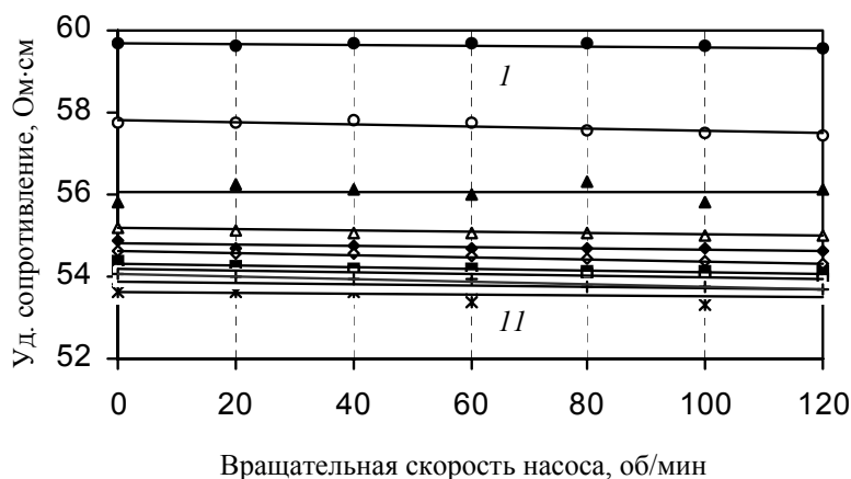
Рис. 10. Зависимость удельного сопротивления 0,9 % раствора NaCl от скорости течения жидкости в трубке длиной L = 23 см (а) при частоте переменного тока 20, 50, 100, 200, 500 Гц, 1, 2, 5, 10, 50 кГц (линии I–II)
