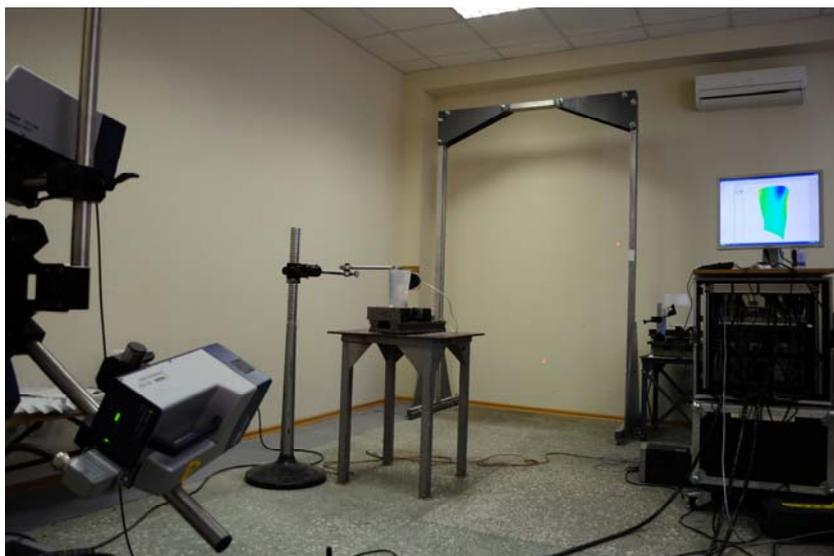
Рис. 7. Исследование собственных частот и форм колебаний модельной полых лопатки вентилятора с помощью трехкомпонентного сканирующего лазерного вибromетра PSV-400-3D
