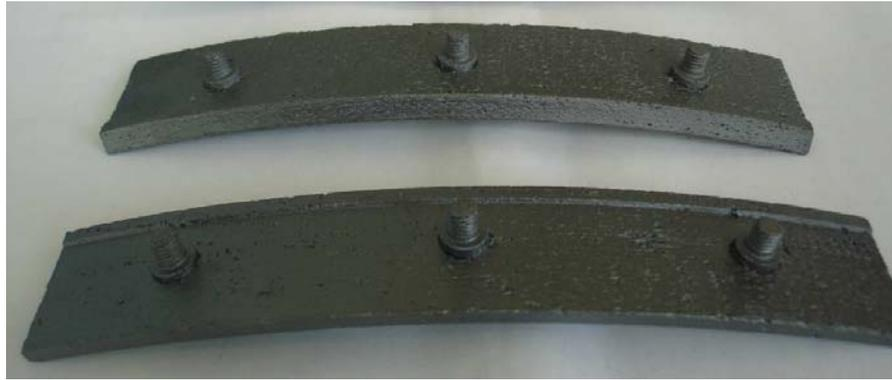
Рис. 12. Модельные элементы жаровой трубы из углерод-углеродного композиционного материала
