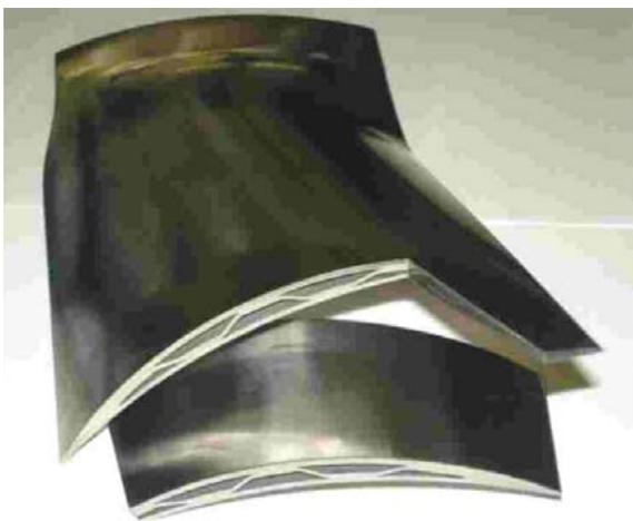
Рис. 4. Модельная полая лопатка вентилятора с наполнителем из наноструктурного титанового сплава
