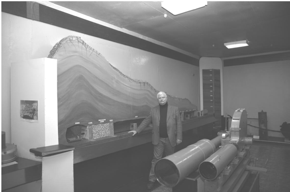
*Макет штольни испытательной площадки «Дегелен». Ядерное устройство располагалось в концевом боксе. По стволу штольни, через элементы забивки проходила труба канала вывода излучения от заряда к измерительным датчикам. На заднем плане виден макет скважины испытательной площадки «Балапан». Заряд опускался в нижнюю часть скважины по специальной спусковой колонне, параллельно опускалась приборная подвеска с датчиками измерения параметров взрыва*
