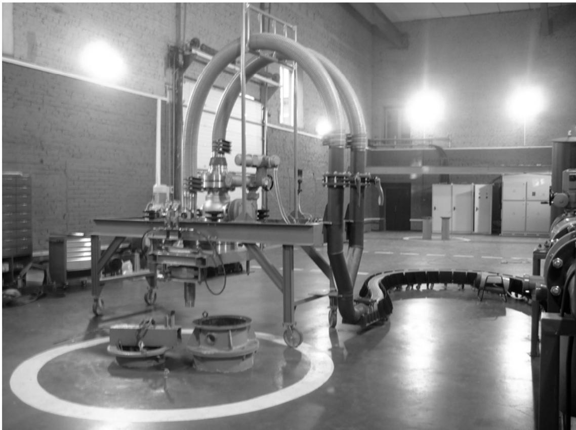
*Стенд-скважина для испытания погружного оборудования*
