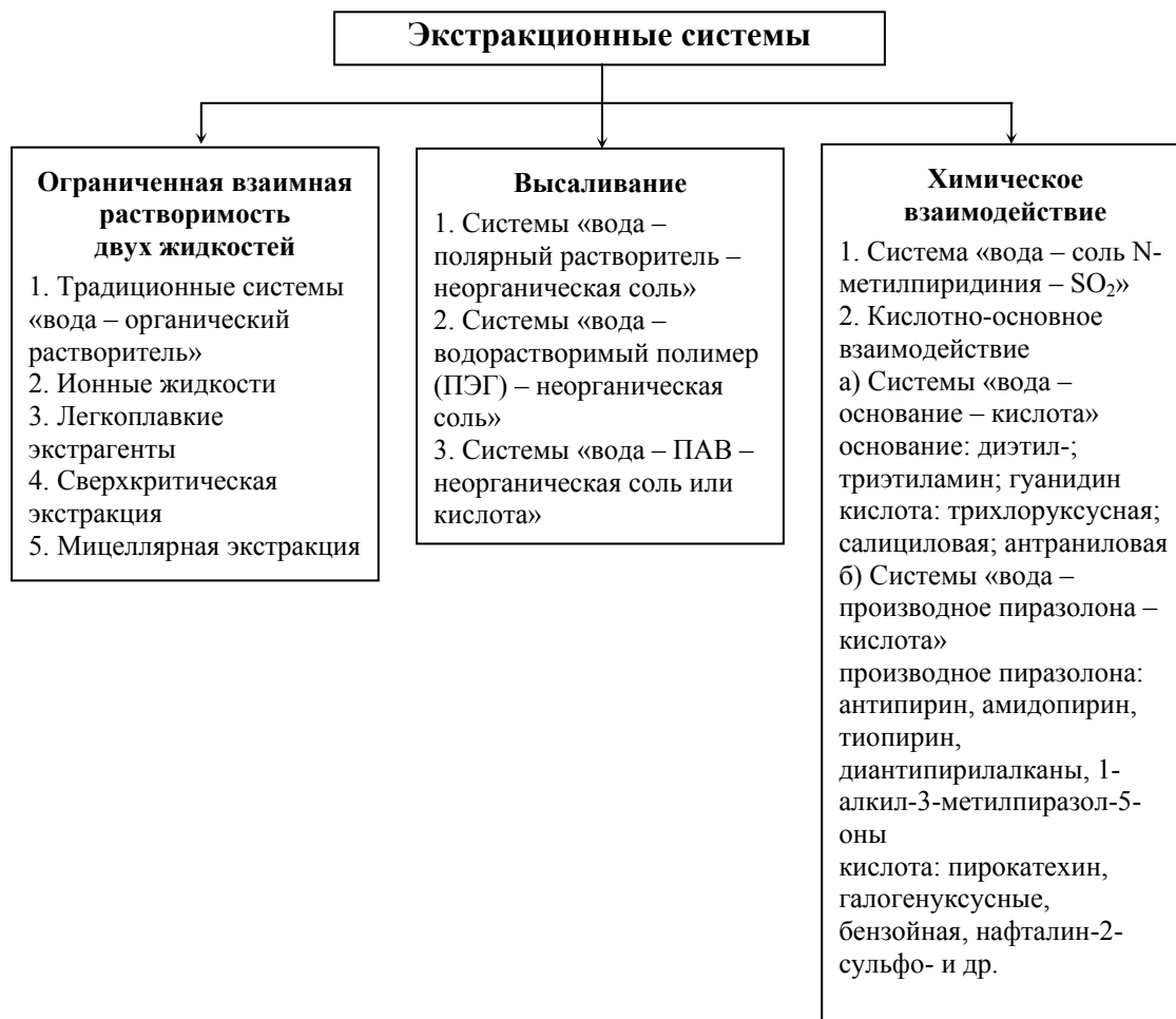
Рис. 1. Классификация экстракционных систем по характеру расслаивания на две жидкие фазы
