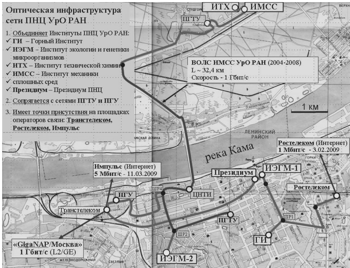
Рис. 5. Оптическая инфраструктура сети ПНЦ УрО РАН
