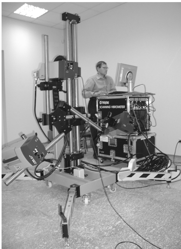
Рис. 3. Проведение экспериментов по определению собственных частот и форм колебаний элементов газотурбинных двигателей с помощью трехпозиционного сканирующего лазерного виброметра
