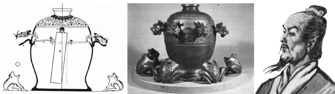
Рис. 1. Современная реконструкция сейсмографа, изготовленного Чжан Хэном в 132 г. н.э.
