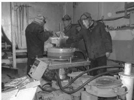
Рис. 4. Процесс непрерывного литья алюминиевых слитков с использованием МГД-перемешивателя, разработанного и изготовленного в Институте механики сплошных сред УрО РАН. Процесс литья осуществляется в ВАМИ
