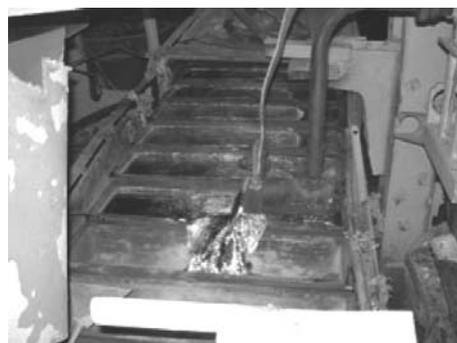
Рис. 7. Момент розлива магния в изложницы на конвейере при помощи насоса
