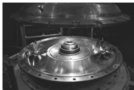
Рис. 3. Канал экспериментальной динамо-установки. Этот канал будет заполнен жидким натрием и раскручен до 2000 оборотов в минуту. Резкое торможение канала вызывает в нем винтовой поток жидкого металла, который и должен обеспечить эффект генерации магнитного поля
