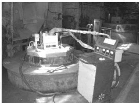
Рис. 6. Электровихревой МГД-насос установлен на тигель с жидким магнием для разлива металла в крупногабаритные слитки на Соликамском магниевом заводе
