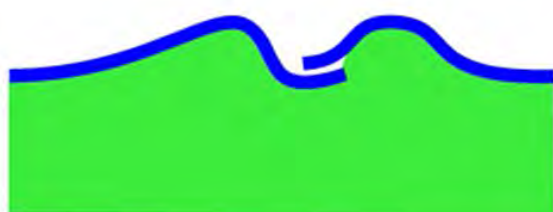
Рис. 6. Схема, иллюстрирующая возможный механизм формирования трещин третьего типа, в которых происходят адгезионный отрыв и наложение одного берега на другой
