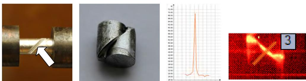
Рис. 3. Образец между входным и выходным стержнями Гопкинсона–Кольского; образец после испытания; распределение температуры по координате перпендикулярно области сдвига и инфракрасное изображение в процессе деформирования, материал АМг6
