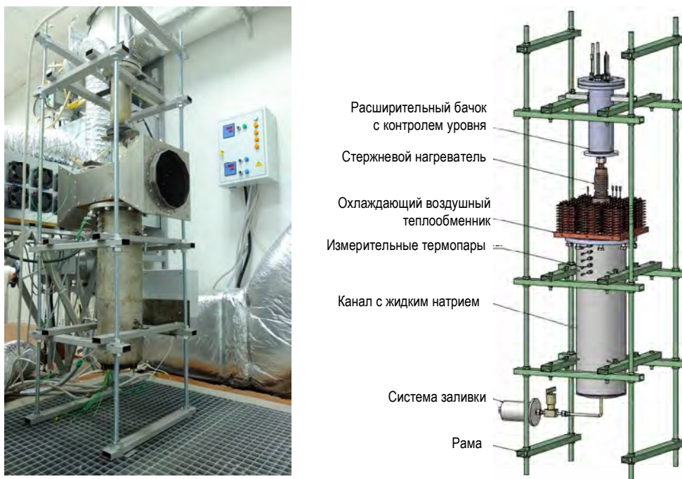
а б Рис. 3. Экспериментальная установка: фото (а) и схема (б)
