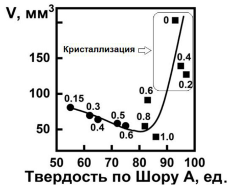
Рис. 11. Зависимость объемного износа образцов эластомеров от твердости по Шору А образцов серии СПВ (■) и образцов серии ПШБ (●). Рядом с точками указано соответствующее молярное содержание МОСА в отверждающей смеси
