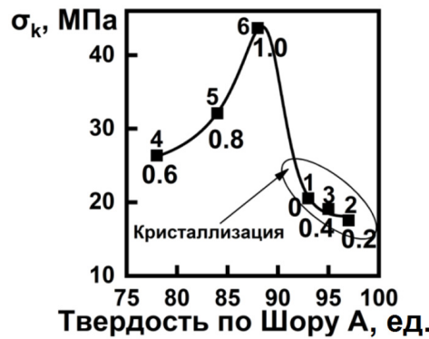
Рис. 10. Зависимость прочности образцов серии СПВ от твердости по Шору А. Над кривой – нумерация точек на рисунке, соответствует номерам образцов серии СПВ. Под точками указано соответствующее молярное содержание МОСА в отверждающей смеси
