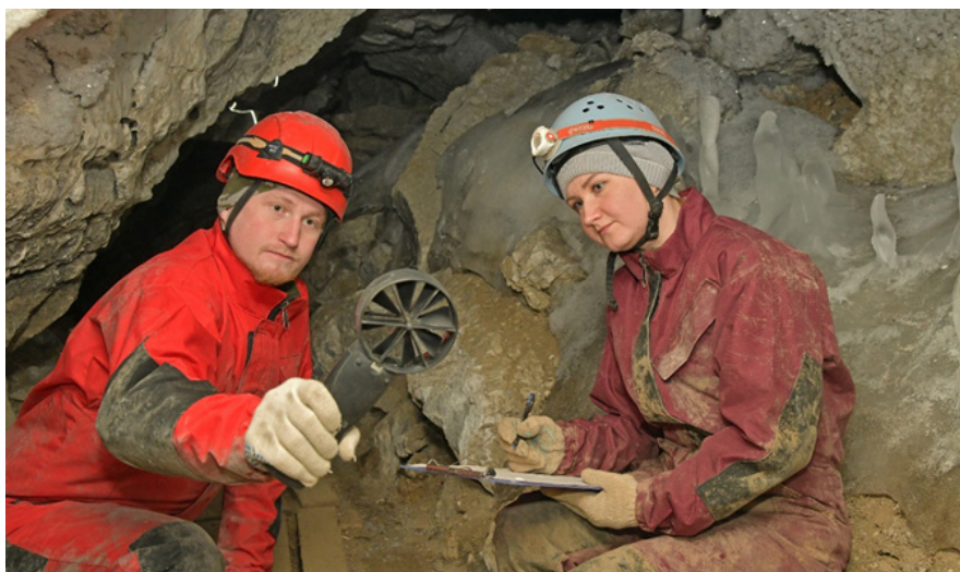
Рис. 6. Измерение скорости воздушного потока в проходе Горе Толстякам и Высоким
