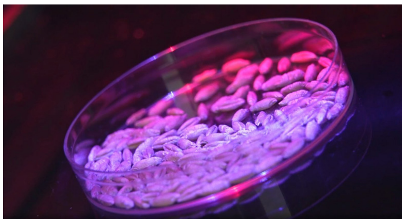
Рис. 3. Обработка семян зерновых культур в лабораторной лазерной установке
