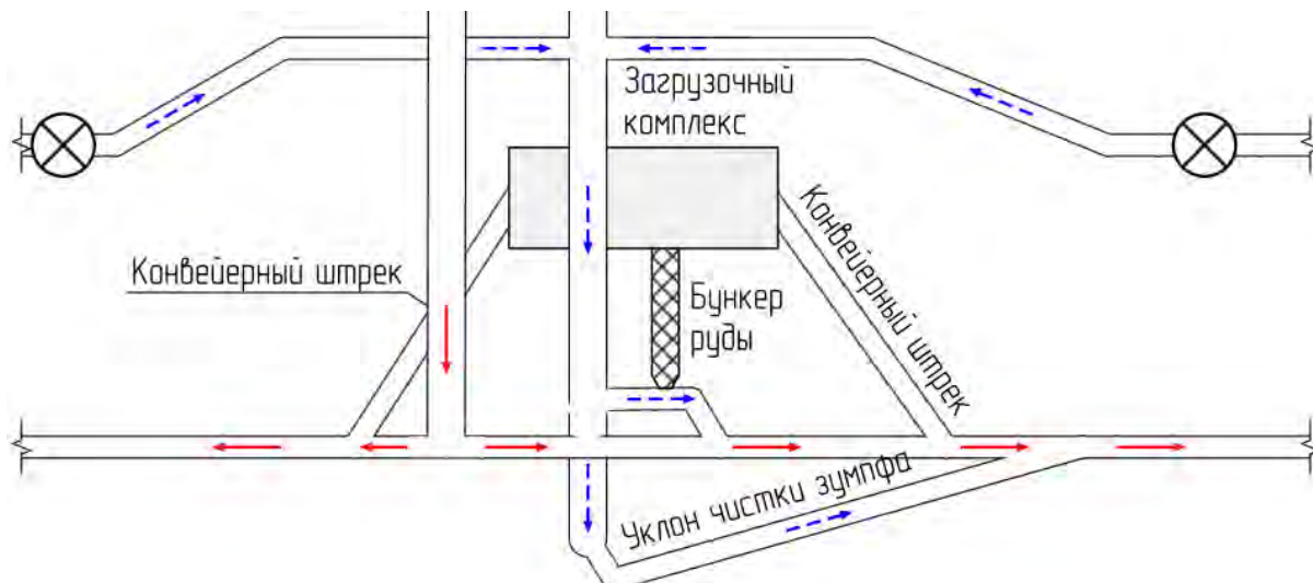
Рис. 1. Движение воздуха при подземном размещении ГБУ
