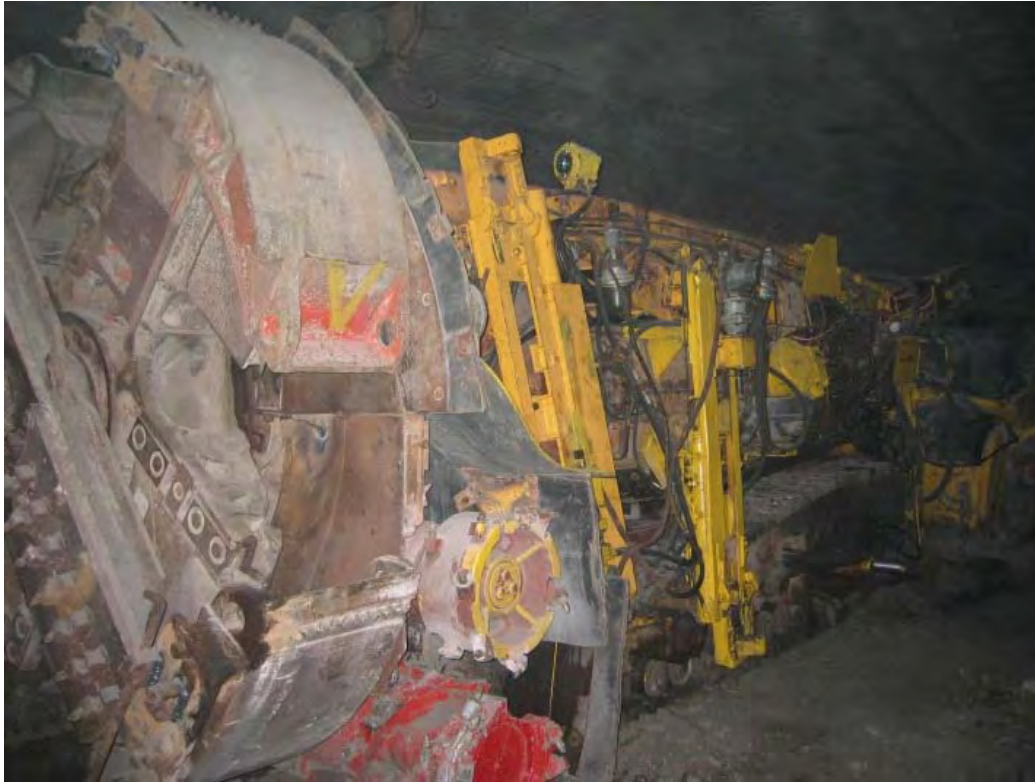
Рис. 2. Расположение буровой установки на комбайне ПКС-8
