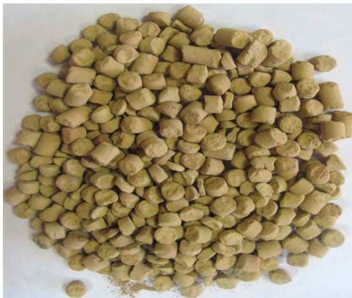
Рис. 1. Огарок обожженный при температуре 900 0 С
