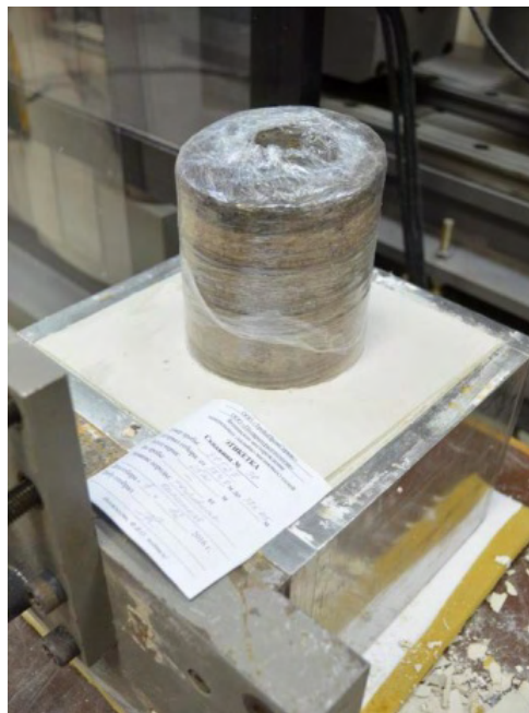
Рис. 2. Подготовка образца к проведению сдвиговых испытаний
