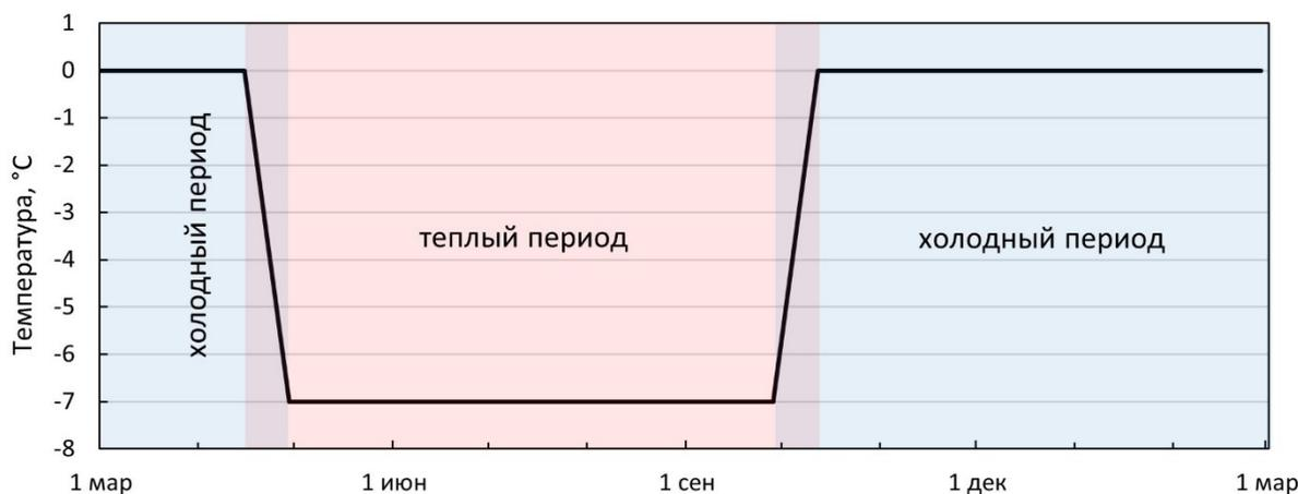
**Рис. 2.** Относительное изменение температуры хладоносителя в рассольной сети для компенсации влияния климатического фактора в теплое и холодное время года
