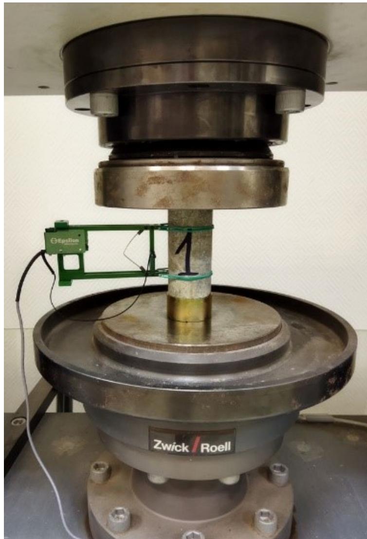
Рис. 1. Проведение испытаний на одноосное сжатие при изучении характера деформирования деструктивного слоя образцов горных пород
