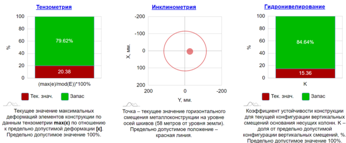
Рис. 4. Интегральные критерии состояния надшахтного здания по результатам тензометрии, инклинометрии и гидронивелирования (измерения оседаний)
