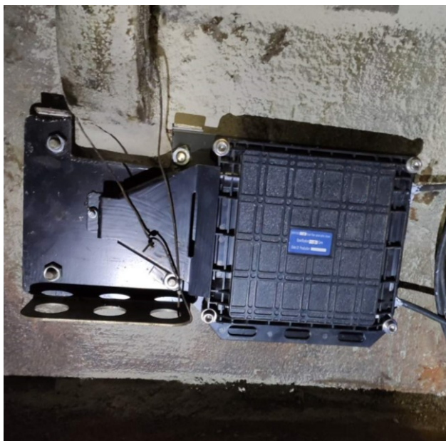
Рис. 2. Опволоконный датчик конструкции «ГИ УрО РАН», установленный в термометрический шпур через технологическое отверстие в тубинговой крепи
