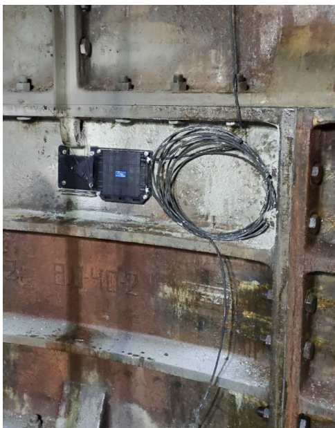
Рис. 2. Опволоконный датчик конструкции «ГИ УрО РАН», установленный в термометрический шпур через технологическое отверстие в тубинговой крепи
