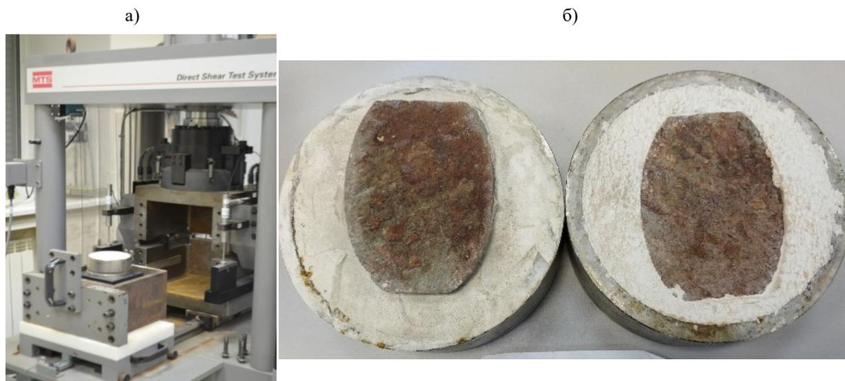
Рис. 2. Подготовка образца к испытанию в сдвиговой установке MTS-816 (а), поверхность трещины скальных пород после испытания на сдвиг (б)
