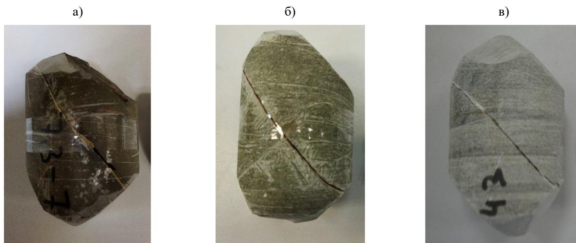
Рис. 1. Внешний вид образцов с трещинами: а – алевролит; б – диорит; в – песчаник
