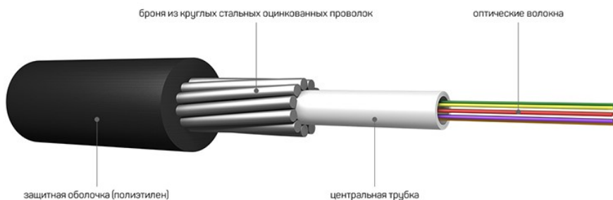
Рис. 11. Конструкция волоконно-оптического кабеля
