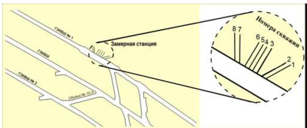
Рис. 3. Конструкция замерной станции в главном западном конвейерно-вентиляционном штреке № 1
