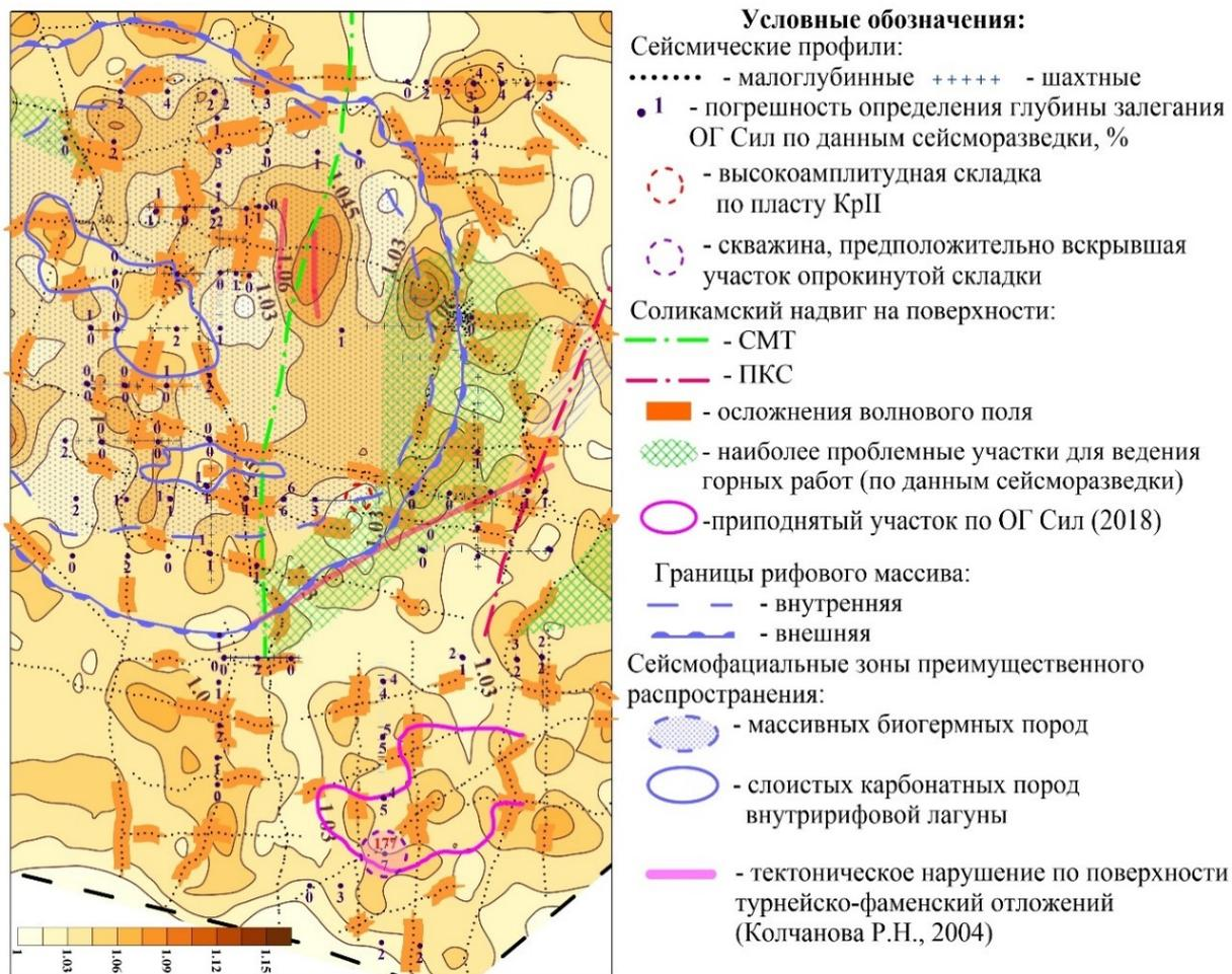
**Рис. 3.** Схема сопоставления распределения комплексного параметра с известными особенностями геологического строения и результатами качественной интерпретации
