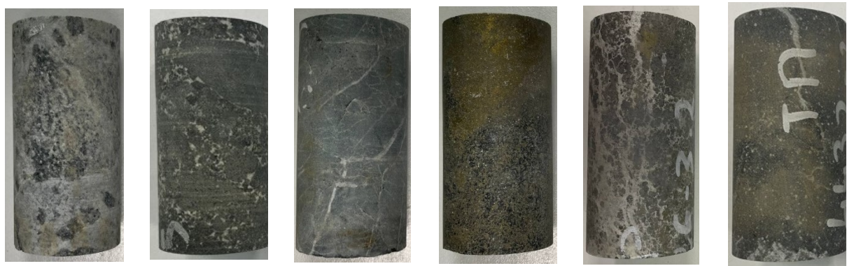
Рис. 2. Вид изготовленных образцов: а – туф; б – лава; в – алевролит; г – медно-колчеданная руда; д – колчеданно-полиметаллическая руда; е – туфопесчанник
