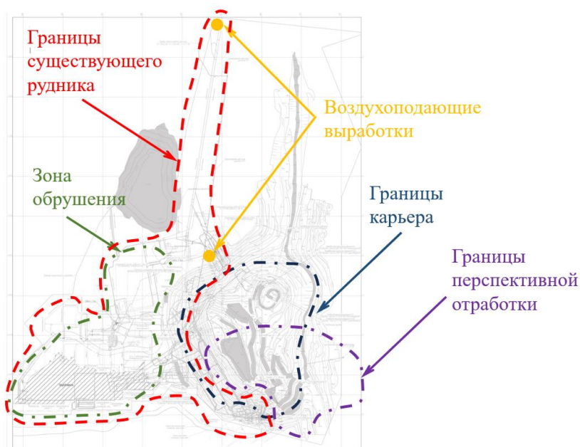
Рис. 3. Возможные места аэродинамических связей карьера с подземным рудником
