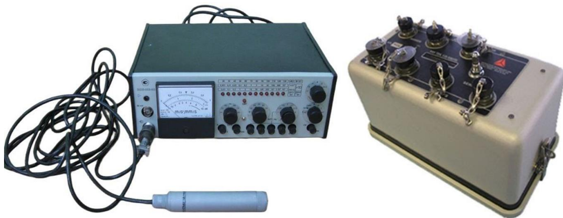
Рис. 1. Шумомер ВШВ-003-М2 (слева) и регистратор Ref-tek 130 (справа)
