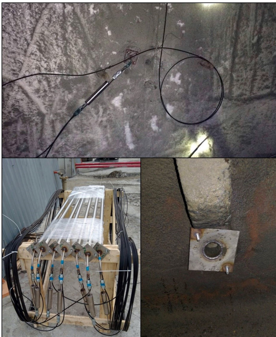
Рис. 3. Оптоволоконные датчики 1-го поколения (Петриковский ГОК)
