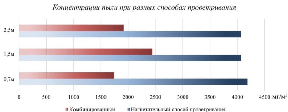
Рис. 4. Сравнение нагнетательного и комбинированного (с преобладанием всасывающего) способов проветривания в районе кабины машиниста комбайна
