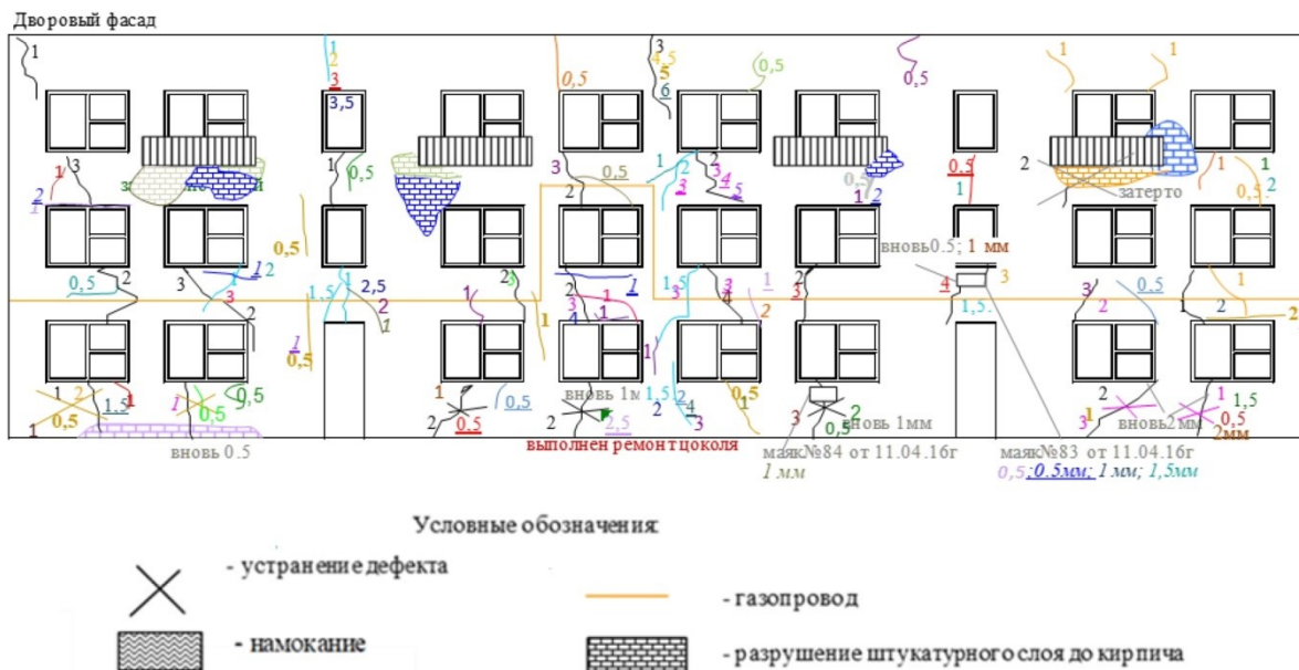
Рис. 1. Пример эскиза фасада жилого дома с нанесенными дефектами наружных стен, выполняемого специализированной службой ПАО «Уралкалий»
