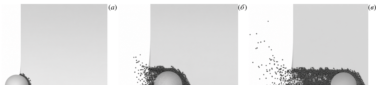
Рис. 4. Трехмерное моделирование эксперимента 0.1 – кинограмма внедрения ударника в преграду в разные моменты времени t , мкс: 0.2 (а); 1 (б); 2 (в)
